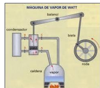
Imagen 2: Máquina de vapor de James Watt. Fuente: tecnologias.us . Autor: Desconocido. Licencia: Desconocida.
