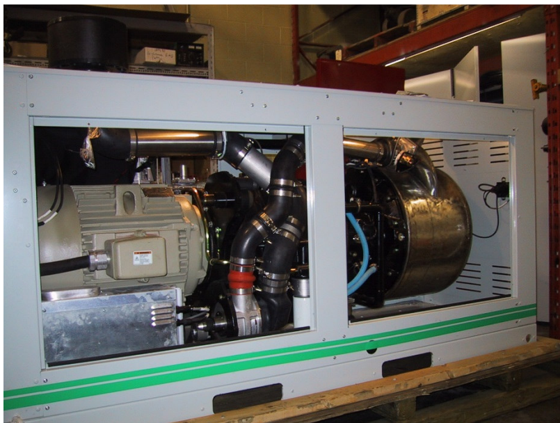
Imagen 15: Motores Stirling , capaz de producir electricidad a partir del calor producido en la combustión de la biomasa . Licencia: Dominio público.
