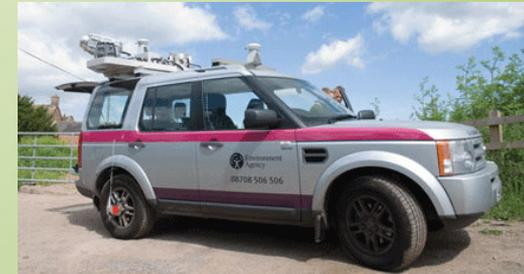
Figura 1 El Lynx Mobile Mapper montado sobre un vehículo de campo
